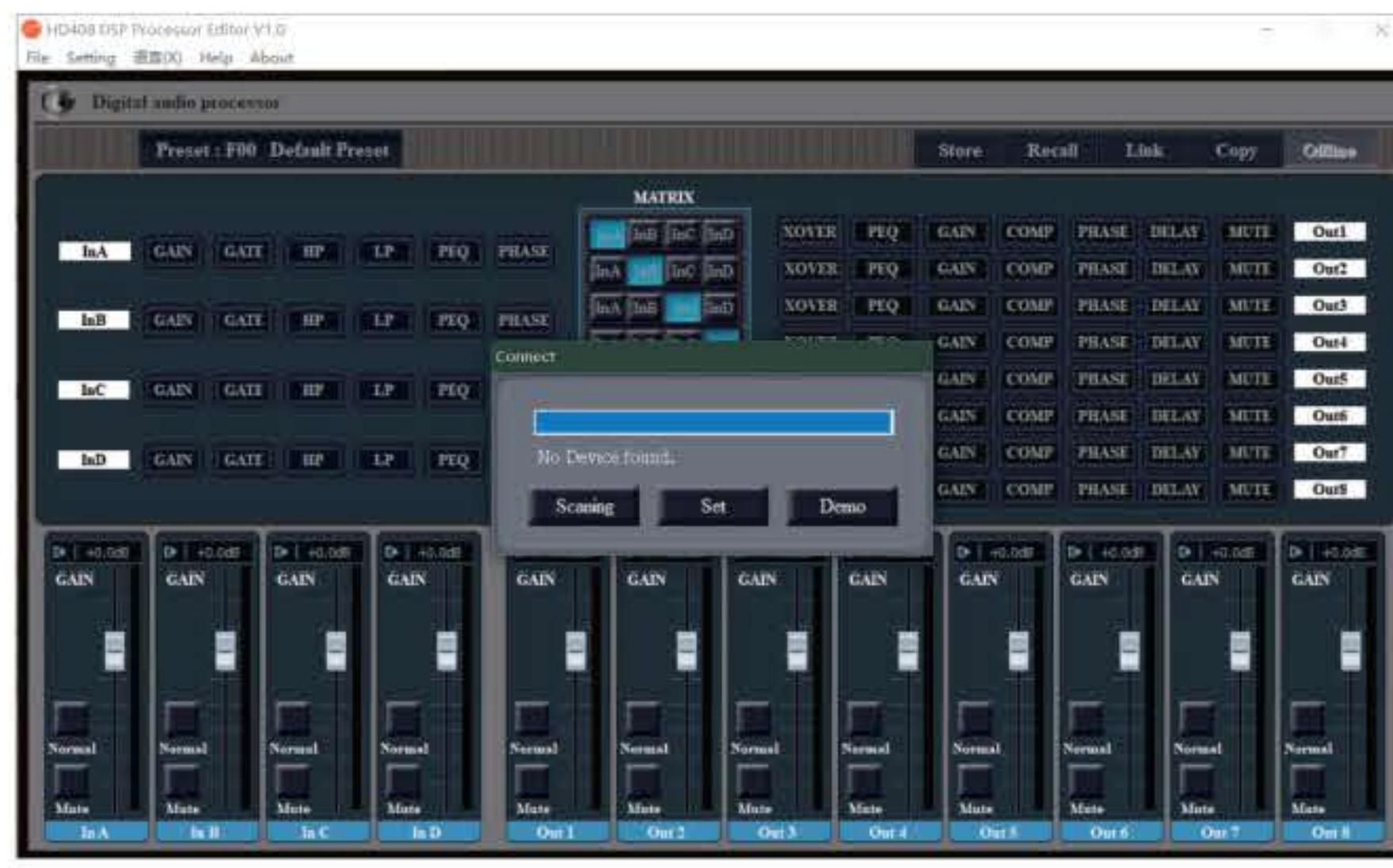
二，将电脑和处理器用USB数据线连接起来，打开处理器电源，此时电脑会自动找到新硬件并且提示硬件已安装而且可以使用。
